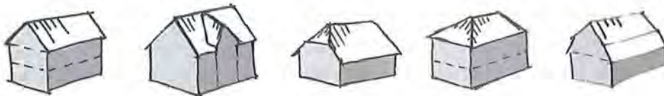
Abbildung 7: Traditionelle Dachformen in der Innenstadt (Satteldach, Satteldach mit Zwerchhaus, Krüppelwalmdach, Walmdach, Mansarddach)
