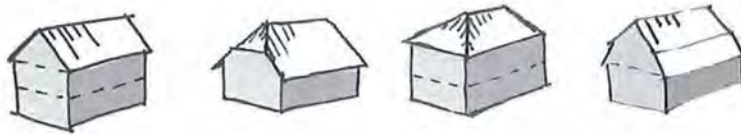
Abbildung 2: Traditionelle Dachformen in der Innenstadt (Satteldach, Krüppelwalmdach, Walm- dach, Mansarddach) Hellgrau straßenseitig = Giebeltyp, Dunkelgrau straßenseitig= Trauftyp
